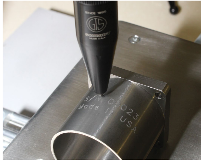
Capaz de marcar partes redondas o planas.
